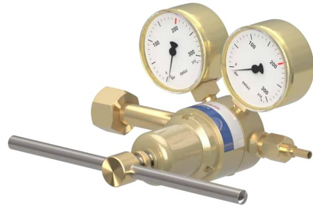
Der EUROJET-H ist ein Druckminderer für höchsten Arbeitsdruck bis 200 bar, z. B. für die Druckprüfung von Anlagen. Für den Ein- und Anbau von Geräten, deren maximaler Betriebsdruck niedriger ist als der höchste Flaschendruck, ist ein zusätzliches Sicherheitsventil notwendig.
