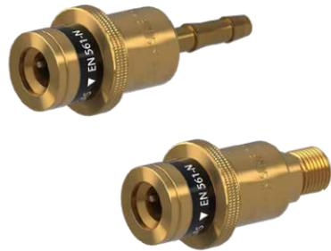
Die EN-Kupplung wurde für den robusten Einsatz konstruiert. Durch ihre Heavy-Duty Dichtmanschette und ihre strömungsgünstige Konstruktion ist sie für die härtesten Einsätze bestens geeignet, und zeichnet sich durch extreme Langlebigkeit aus. Durch die farbige Markierung am Schiebering ist die Gasart, auch von weitem, leicht erkennbar.
