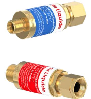
**ACHTUNG** Rückschlagsicherungen / Gebrauchstellenvorlagen sind nach Regelwerk und Gesetzgebung bei Schweiß-, Schneid- und Wärmebehandlungen zwingend vorgeschrieben. Sie sollen verhindern, dass eine Flamme durch die Schlauchleitung oder Gasleitung in die Gasflasche zurückschlagen kann.
