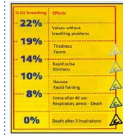
atmosphäre eines geschlossenen Raums verringert den Sauerstoffgehalt und birgt Erstickungsgefahr für die Bediener. Der Sauerstoffgehalt für atembare Luft muss zwischen 19 und 21 % liegen.
