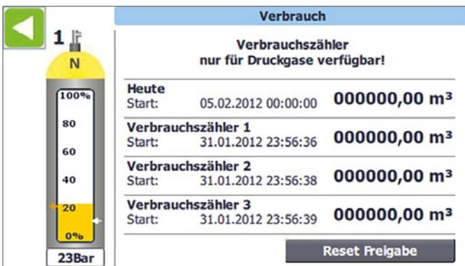
„Seit Anschluss“ wird automatisch zurückgesetzt, wenn eine neue Flasche angeschlossen wird. Der Neuanschluss einer Gasflasche wird erkannt, wenn der Flaschenfüllstand bzw. Druck für 2 Minuten größer als die eingestellte Warngrenze ist.
