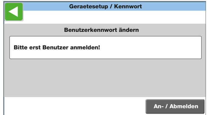
11.4.2 Wenn der Benutzer noch nicht angemeldet ist, erscheint das Bild oben. Durch Klicken auf „An- / Abmelden“ muss zuerst das aktuelle Passwort eingegeben werden, damit es anschließend geändert werden kann. Passwort eingeben (Tastaturfenster) und mit OK bestätigen.
