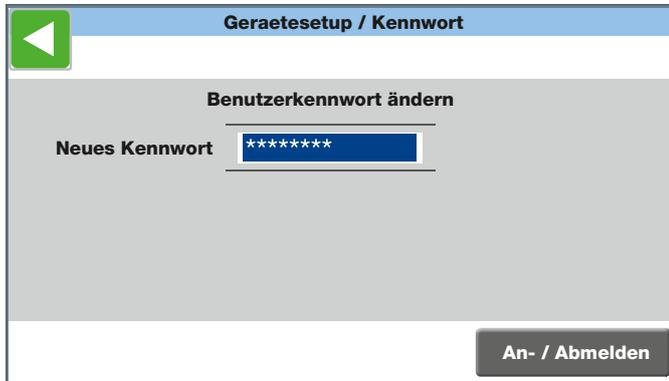
11.4.5 Wenn das Kennwort des Benutzers verloren gegangen ist, kann man sich temporär mit 9999 am Gerät anmelden und anschließend so wie oben beschrieben ein neues Passwort für den Benutzer eingeben.
