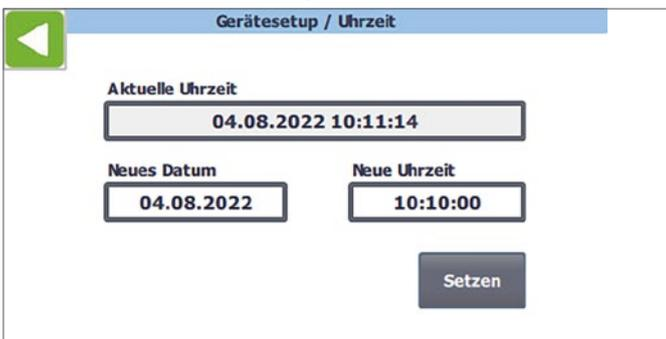
11.3.2 Hier kann die Systemuhr gestellt werden. Dafür muss im Feld „Neue Uhrzeit“ das Datum und die Uhrzeit im vorgegebenen Format eingegeben und anschließend durch Drücken von „Setzen“ übernommen werden.
