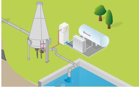
Der INJECTOR-BICONE dient als statischer Misch-Reaktor. Er trägt bei geringem Druckverlust, platzsparend, effizient und verlustfrei die erforderliche Menge an CO<sub>2</sub> in das Abwasser ein.
