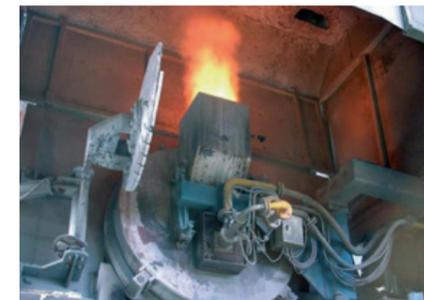
Abb. 7 ALBATICH-Brenner in einem kippbaren Aluminium-Drehtrommelofen
