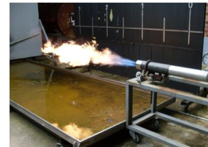
Abb. 6 ALBATICH-Brenner für Drehtrommelöfen
