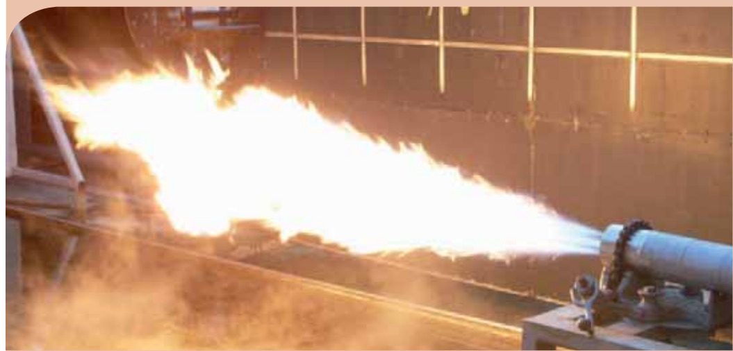
Abb. 3: Der BoostAL Control HI Hochimpuls-Sauerstoffbrenner hat einen hohen Flammenimpuls und eine lange, buschige Flammgeometrie
