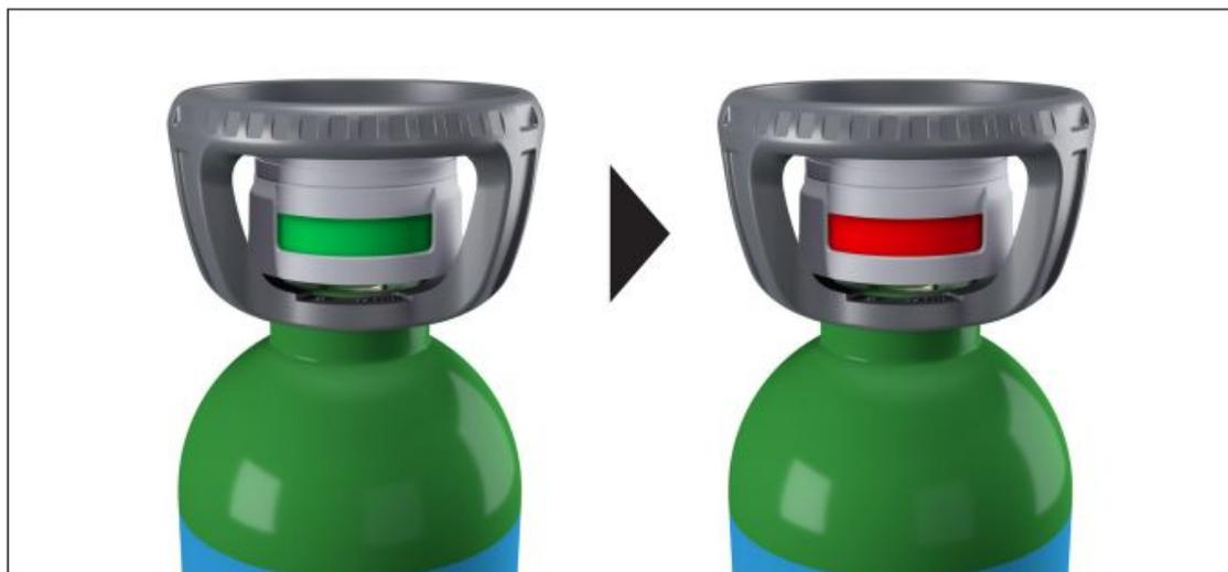
Die Flaschenwechsel-Anzeige (4) weist visuell auf einen geringen Inhalt (Druck) der Qlixbi-Flasche hin. Sie ist binär, d.h. sie wechselt von grün auf rot, wenn die Reserve erreicht ist und der Gasvorrat zu Ende geht. Mit dem Farbwechsel verbleibt eine Schweißzeit von ca. 30 Min. bei einem angenommenen Verbrauch von 15 l/min.
