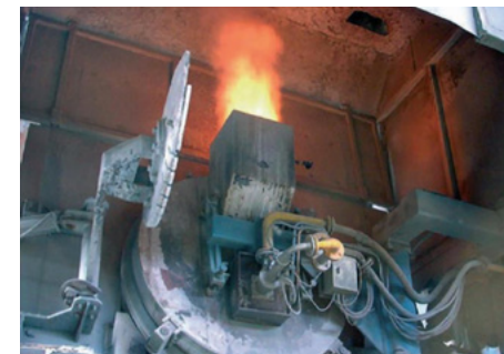
Abb. 7 ALBATCH-Brenner in einem kippbaren Aluminium-Drehtrommelofen
