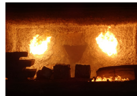
Abb. 8 Herdofen mit Sauerstoffbrenner
