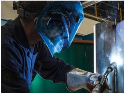
MAG-Schweißen hochlegierter Stähle
