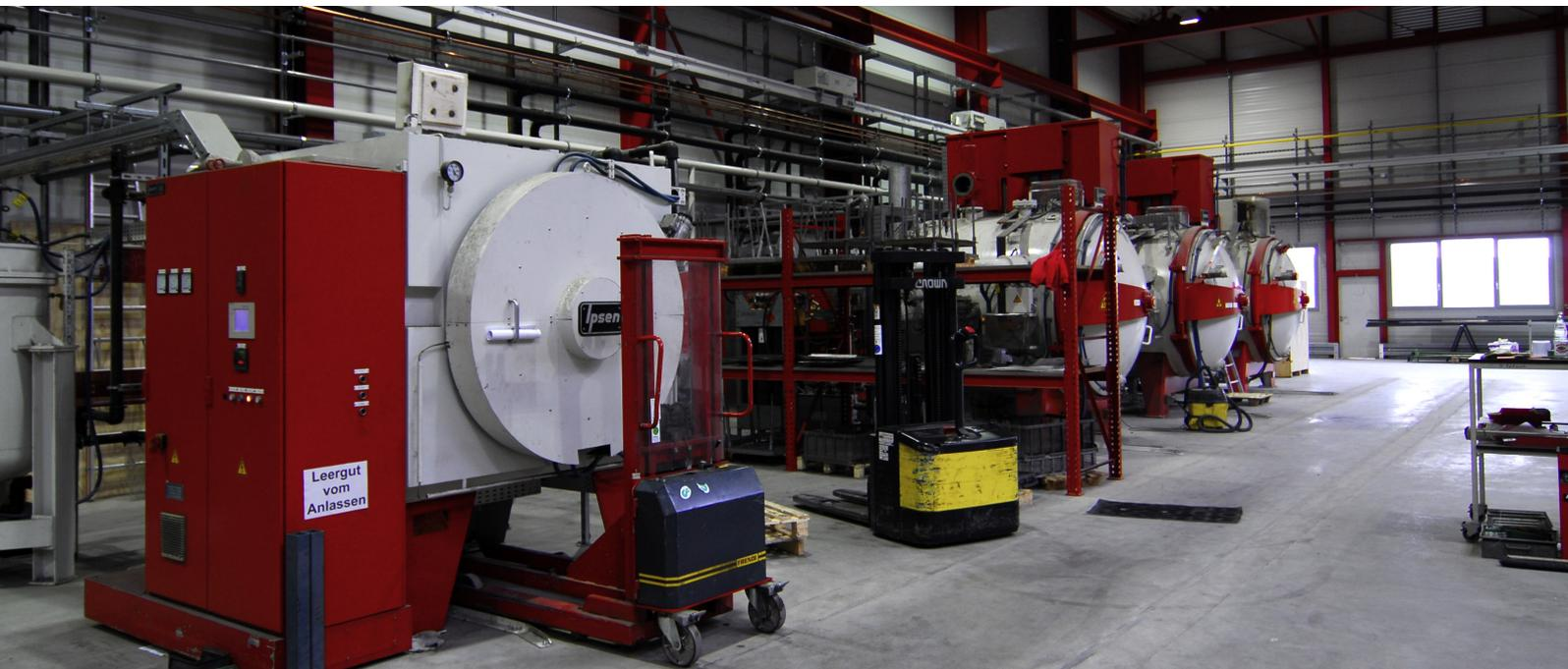
Mit Nitrierverfahren werden harte und verschleißbeständige Oberflächen durch die Bildung einer Verbindungs- und Diffusionsschicht erzeugt.
