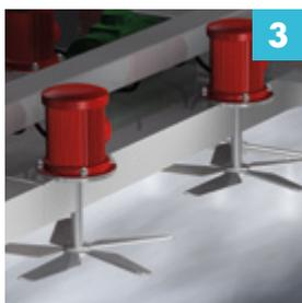
**3** Bis zu 12 regelbare Ventilatoren oberhalb des Bandes sorgen für eine gleichmäßige Verteilung des Stickstoffs. Die produktspezifisch regelbare Umluftgeschwindigkeit sorgt für beste Effizienz und beschleunigt den Gefrierprozess. Durch die optimale Nutzung der Gaskälte minimieren Sie die Verbrauchskosten an Gas.
