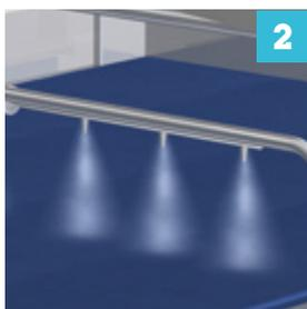
**2** Eine Düsenanlage oberhalb des Transportbandes stabilisiert die Oberfläche und Form der Produkte. Weiche, klebrige oder pastöse Produkte können schnell gefrosten werden, ohne zu zerlaufen. Durch die Versiegelung der Produktoberseite wird Wasserverlust vermieden und eine optimale Formstabilität erreicht.
