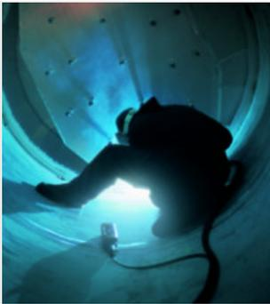
*TERAL, die Lösung von Air Liquide zum manuellen und maschinellen MAG-Schweißen von unlegierten und niedriglegierten Stählen*
